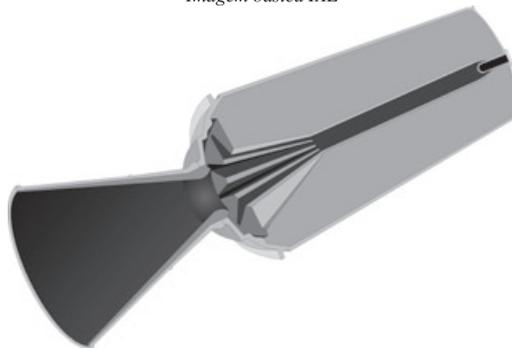
Figura 5.2.10 Aspecto interno do bloco de propelente do motor S43
