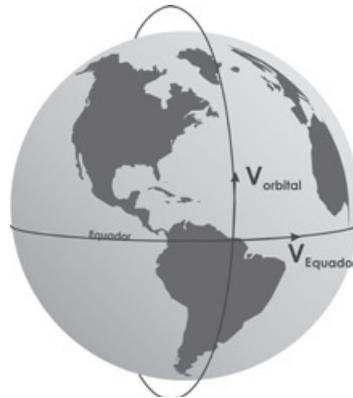
*Figura 4.30 Efeito da velocidade do campo equatorial no lançamento polar*
