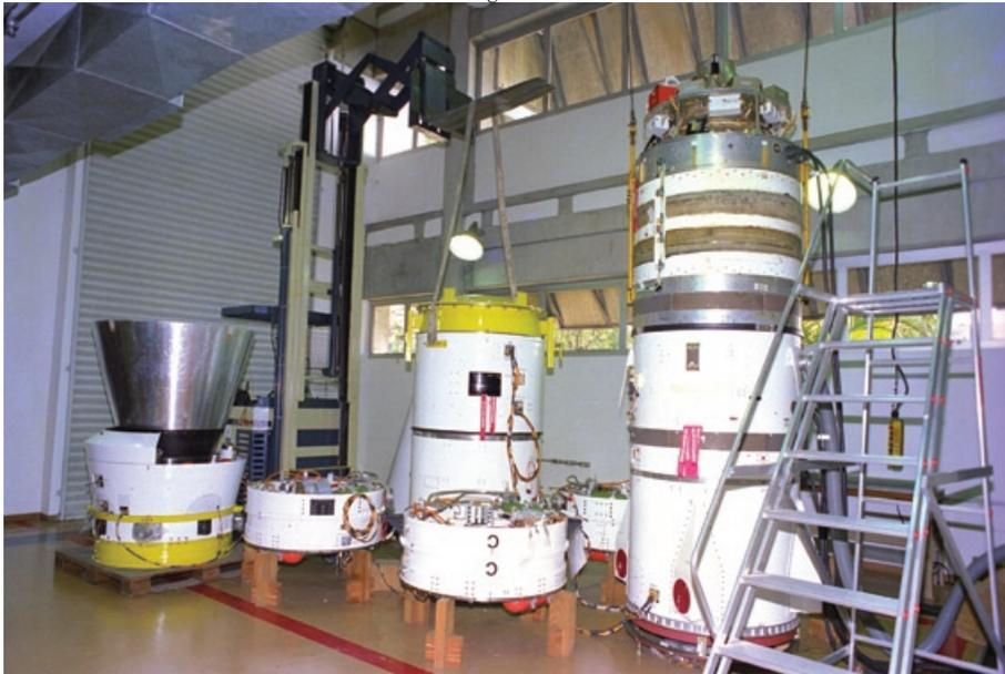
*Figura 6.5 Testes da rede elétrica do VLS-1*
