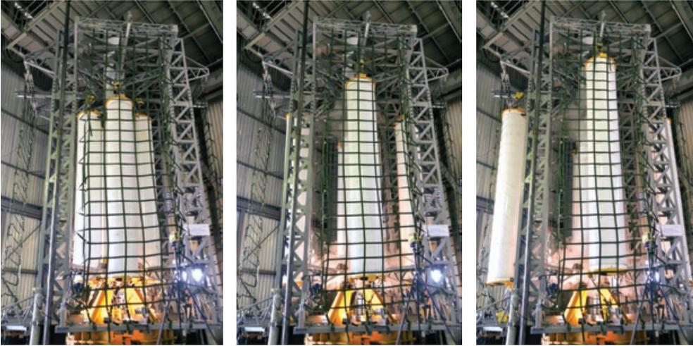
*Figura 6.7 Sequência do ensaio de separação completa do 1º estágio VLS-1*
