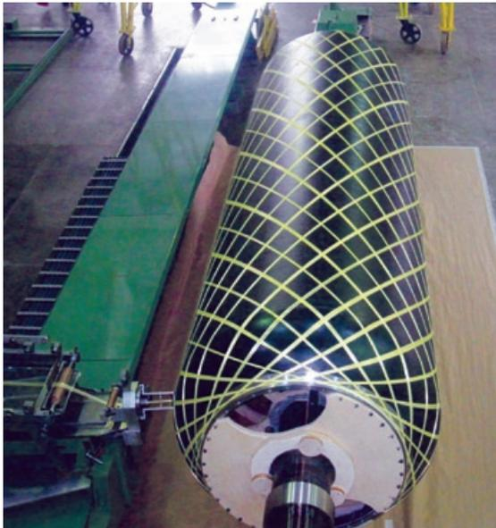
*Figura 5.4.12 Envelope motor sendo bobinado*
